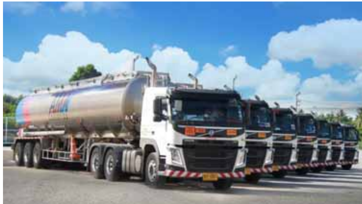
รถบรรทุกน้ำมัน (รถเทรลเลอร์พ่วง 22 ล้อ)
